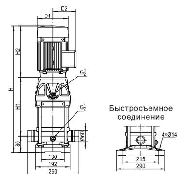
CDM / CDMF5-21 - 5-33 не имеют исполнения с овальным фланцем. Габаритно-присоединительные размеры однофазного электродвигателя и взрывозащитного двигателя имеют отличия от стандартных значений. Пожалуйста, обратитесь в представительство в вашем регионе для уточнения.
