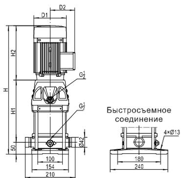
CDM / CDMF1-27 ~ 1-40 не имеют исполнения с овальным фланцем. Габаритно-присоединительные размеры однофазного электродвигателя и взрывозащитного двигателя имеют отличия от стандартных значений. Пожалуйста, обратитесь в представительство в вашем регионе для уточнения.
